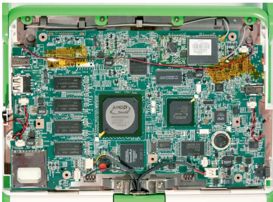
Die Hauptplatine des XO steckt hinter dem Panel im Displaydeckel. In der Mitte prangt der AMD Geode, rechts daneben die Southbridge.
